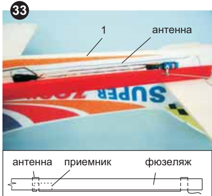
33 Прodelайте 4 отверстия для антенны в фюзеляже. Проложите антенну таким образом, как показано на рисунке.
