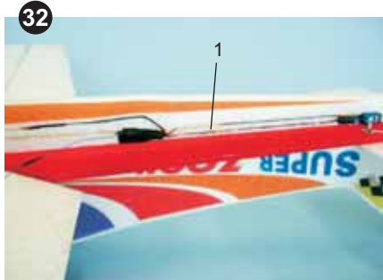
32 Необходимо расположить приемник таким образом, чтобы не мешали провода других устройств. Прорежьте паз для приемника. Прорежьте пазы для проводов бортовых систем. Проложите провода в пазы.
