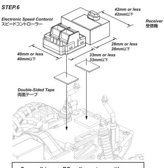
Some all-in-one RC radio systems with a receiver and speed control cannot be used. 受信機とスピードコントローラーが 一体式となっているメカは使用できません。
