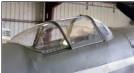
Если элементы переплета прямолинейны по форме, их изготавливают из заранее нарезанных (с припуском по длине) полосок целлулоида нужной ширины. Полоски приклеивают клеем по месту, и после того как клей окончательно высохнет, излишки полоски обрезаются резаком (канцелярским ножом).
