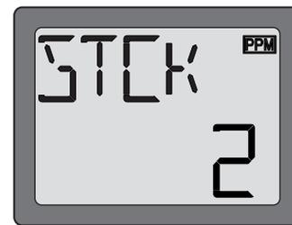
Для изменения режима одновременно нажмите кнопки **режим** и **выбор** и включите передатчик. На дисплее отобразится текущий режим. Нажмите движок **ввод данных** вверх или вниз для изменения режима. Если выбран такой режим, когда газом управляет правая ручка, то туда же долже быть перемещен и предохранитель газа. Это может быть сделано в сервис цетре Futaba Service Center. (См. стр. 2)
