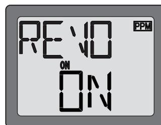
3. Один раз нажмите кнопку **выбор**. Это вызовет появление на экране мигающего знака «%». Величина микширования устанавливается для нижнего и верхнего положения ручки управления газом отдельно. Когда Вы сдвигаете ручку управления вниз, вниз перемещается и стрелка на экране. Нажимая движок **ввод данных** вверх или вниз установите степень микширования снизу. Переведите ручку управления вверх, стрелка переместится вверх и можно установить степень микширования сверху.
