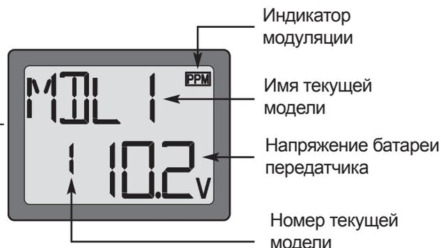
**Замечание:** Свободно перемещайтесь по программам смотря на дисплей, используя кнопки **режим** и **выбор**. Эти кнопки только определяют, что отображается на дисплее и не меняют установок. Изменение установок производится только движком **ввод данных**.
