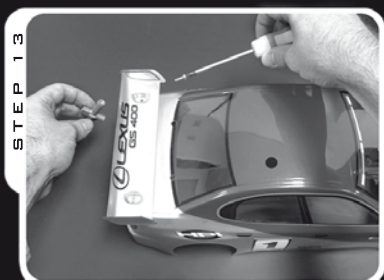
STEP 13 Secure wing with screws and nuts if provided with body. 付属のネジ等でウィングを取り付けます。
