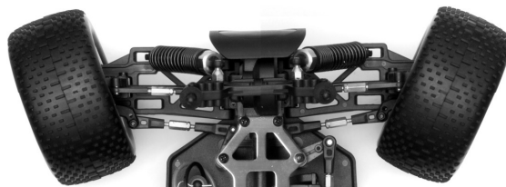
Paramètre d'ouverture exagéré (Ne pas le faire souvent!)
