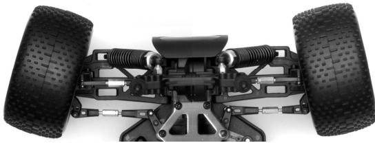
Übertriebene Einstellung der Vorspur (nie so stark einstellen!)
