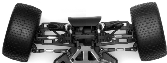
Paramètre de pincement exagéré (Ne pas le faire souvent!)
