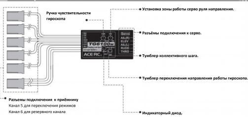
Если вы пользуетесь 4х-канальным радио, оставьте 5 и 6 каналы неподключёнными.
