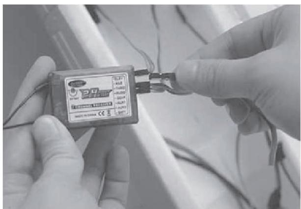
**13** Вставьте Y-образный кабель элеронов в канал AILE в приемнике.
