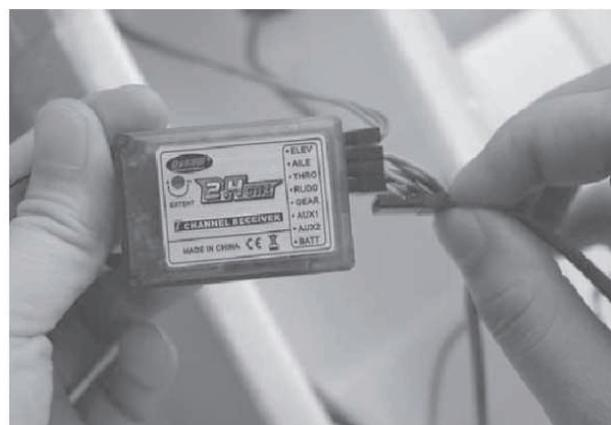
**14** Вставьте Y-образный кабель управлением шасси в канал GEAR на приемнике.
