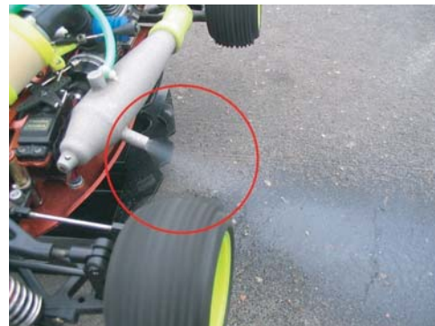
Дроссель - 100%. Двигатель издает резкий звук с характерным треском и не раскручивается до максимальных оборотов. При этом наблюдается обильное количество дыма вперемешку с топливом из глушителя. Смесь слишком богатая.
