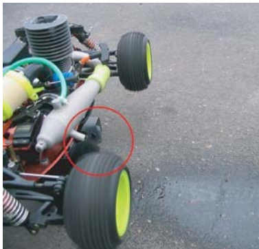
Дроссель - 100%. Двигатель издает короткие глухие звуки и не раскручивается. При этом дыма из глушителя не наблюдается. Смесь слишком бедная.
