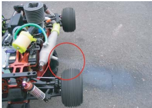
Дроссель - 100%. Двигатель звучит ровно и раскручивается до предела. При этом наблюдается "хвост" дыма из глушителя. Смесь в норме.
