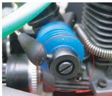
Игла малого газа (low speed needle).
