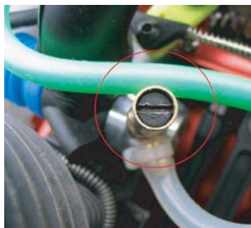
Главная игла (high speed needle).
