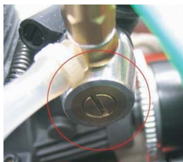
Игла переходных режимов (mid range needle).
