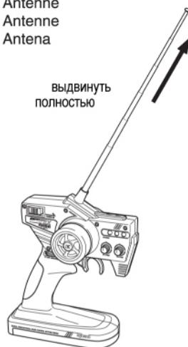
**2** Передатчик (включатель)
