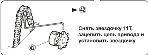
Снять звездочку 11Т, зацепить цепь привода и установить звездочку
