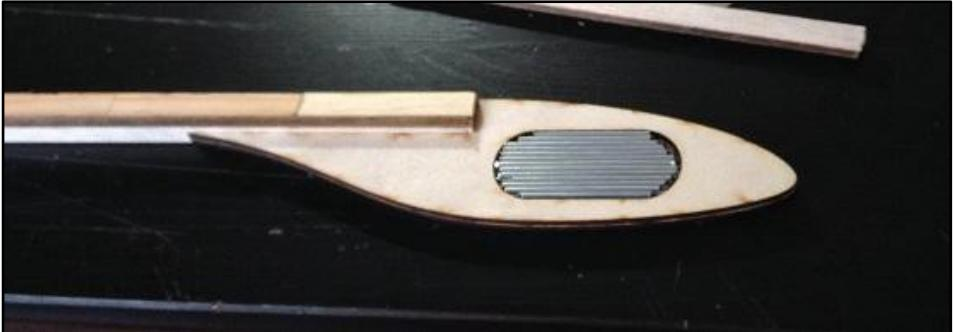
Свинцовый или металлический балансировочный груз (35...40гр) располагается в отверстии носика, фиксируется от перемещения kleem и заклеивается сверху фанерной накладкой.
