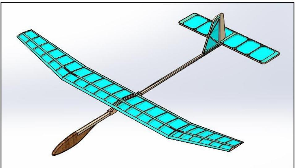
Эту операцию нужно проводить с тщательным контролем взаимной перпендикулярности элементов оперения и ровностью положения стабилизатора относительно балки фюзеляжа при виде сверху.
