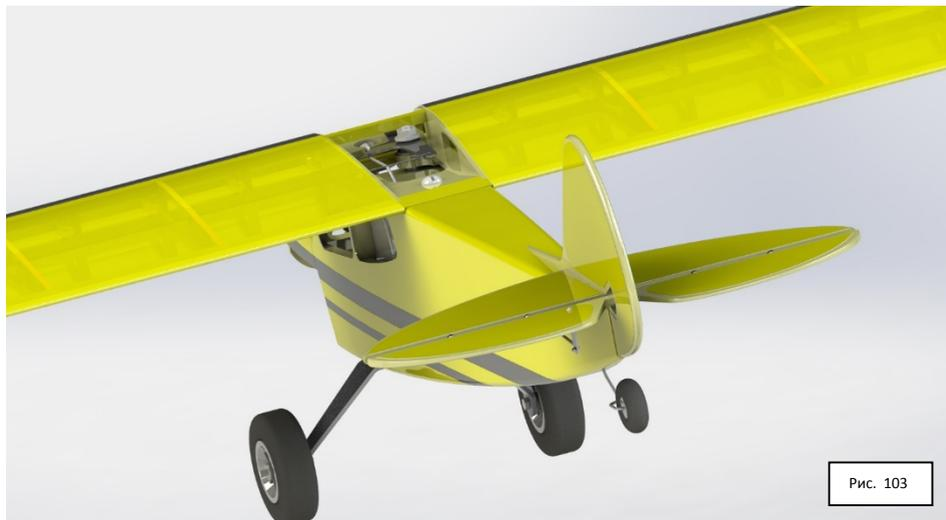
Проверяем работоспособность узла, покачивая тройник управления через гибкие тяги.
