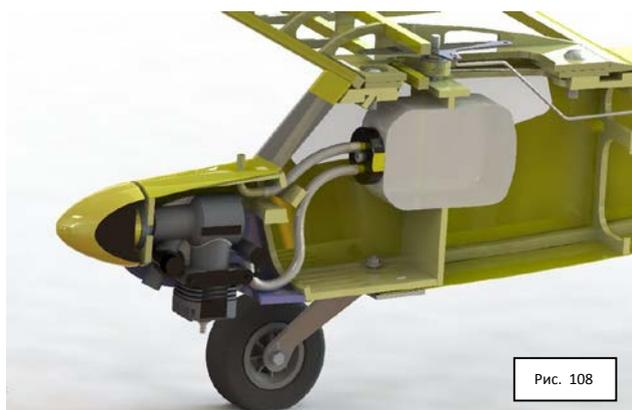
Данная схема удобна тем, что достаточно удобно заправлять двигатель, и в случае необходимости можно организовать наддув топливного бака соединив заправочную трубку с выходным штуцером на глушителе двигателя. (См **рис. 108**)
