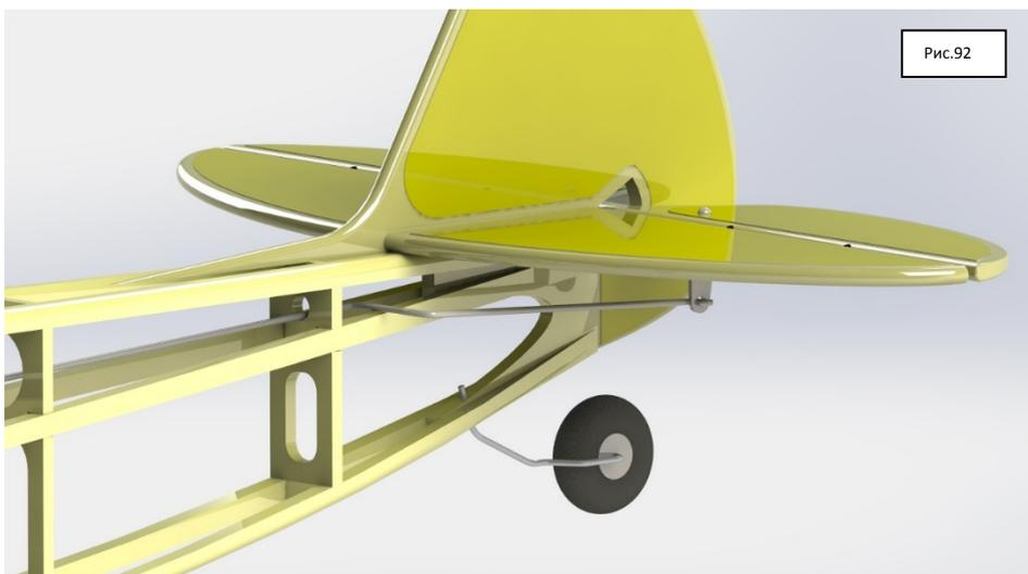
Снимаем крыло, тягу оставляем в фюзеляже и приступаем к оклейке фюзеляжа пленкой.
