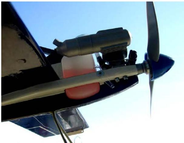
Если вы используете калильный или дизельный двигатель с «карбюратором», то для управления оборотами двигателя не только иглой - мы настоятельно рекомендуем установить на модель «ручку» управления заслонкой карбюратора двигателя.
