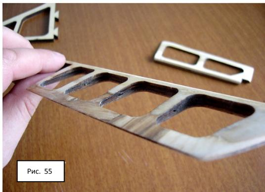
**ВАЖНО !!!** Во время финальной обработки поверхностей, Вы можете столкнуться со скрытыми дефектами используемых материалов (рис. 55).
