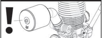
The engine must never be run without the air filter in place! エアフィルターなしでは絶対にエンジンを走らせて下さい。
