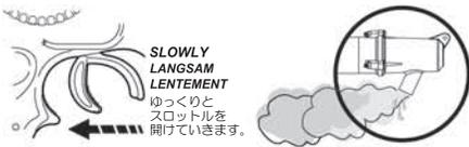
Schalten Sie den Sender und Empfänger ein. Befüllen Sie den Kraftstofftank neu und folgen Sie den Start-Schritten 1-5. Während die Reifen weiter in der Luft sind, geben Sie an der Fernsteuerung langsam Gas. Nachdem Sie Vollgas erreicht haben, gehen Sie wieder vom Gas. Damit entfernen Sie überschüssiges Öl aus dem Motor, welches sich dort durch die fetten Einlauf-Einstellungen ansammelt. Der Motor muß regelmäßig "freigeblasen" werden, damit er nicht verfettet.
