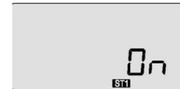
Если вы включили передатчик, и он сразу начал пищать, в то время как на дисплее показалось слово "ON", значит, включен один из режимов условий полёта, отличный от нормального. Символ в чёрном квадратике внизу экрана показывает, который переключатель (SW1 или SW3) нужно установить в нормальное положение.
