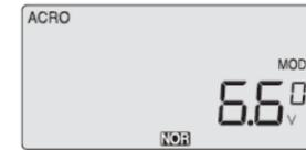
Когда напряжение на батарее падает до 6,6В, эта цифра начинает мигать на экране, и передатчик начинает постоянно пищать. Если ваш самолёт в воздухе, немедленно сажайте его, чтобы зарядить батарею.
