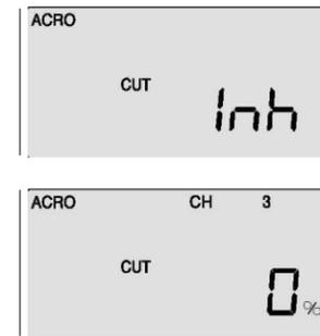
В этом экране вы можете установить значение хода серво газа (вы также можете выбрать направление в программе), так что вы можете немедленно отсечь двигатель, если газ дан меньше чем наполовину, нажатием кнопки "Eng Cut", расположенной в верхнем правом углу передатчика.
