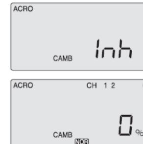
Эта программа позволяет вам микшировать элероны и закрылки или флапероны, чтобы изгибать заднюю кромку крыла вниз или выгибать вверх. Изгиб меняет аэродинамический профиль, чтобы создать больше подъёмной силы, когда вы замедляете ход перед посадкой или для того, чтобы масштабная модель летела более медленно и реалистично. Вы также сможете компенсировать тенденцию модели «зарываться» носом, когда закрылки и элероны опускаются одновременно.
