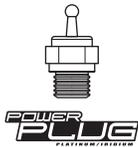
スパークプラグと点火装置によって点火する実車のエンジンと異なり、グローエンジンの点火はグロープラグのみによって行われます。最初はプラグブスターを使用しエンジンに点火しますが、プラグブスターがはずされた後はエンジン燃焼室内の温度によりグロープラグのフィラメントが発熱し次の燃焼を起こします。この繰り返しによりエンジンが回りつづけます。また、グローエンジンの点火時期は回転数、エンジン温度に合わせて変化します。高回転時にはグロープラグが高温になり点火時期が早くなります。反対に低回転時にはグロープラグが低温になり、点火時期が遅くなります。以上のようにグロープラグはエンジンにとって非常に重要な働きをしています。そのためグロープラグの選択、メンテナンスを適切に行うことが大変重要になります。
