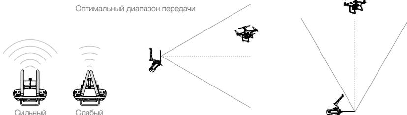
Убедитесь, что полет проходил на расстоянии, не превышающем диапазон оптимального приема/передачи. Чтобы обеспечить максимальное качество приема/передачи, поддерживайте соответствующее расстояние между оператором и летательным аппаратом.
