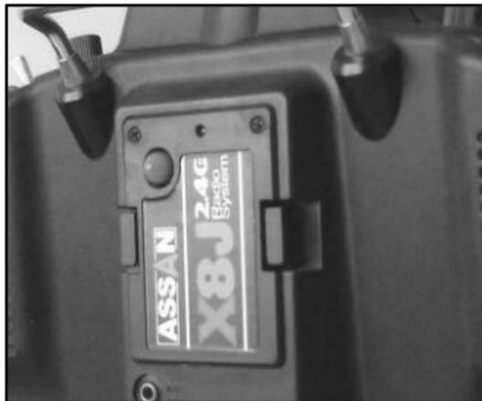
Выньте высокочастотный модуль 2.4ГГц из упаковки (X8F/X8J). Вначале не устанавливайте антенну. Будьте внимательны, чтобы не повредить выступающую часть резьбы на основании антенны.
