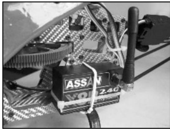
Снимите красную пластиковую заглушку с основания антенны, вращая её против часовой стрелки. Вверните основание антенны в приемник по часовой стрелке. Вворачивайте вручную во избежание повреждения деталей. Разъем антенны универсален. Во время использования антенна должна быть направлена наружу.
