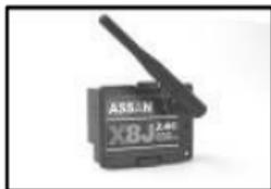
**X8J:** Высокочастотный модуль для передатчиков JR
