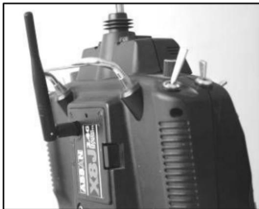
Установите съёмную антенну и завинтите её в разъем на задней поверхности высокочастотного модуля ASSAN X8 2.4ГГц. Не затягивайте сильно, т.к. Вы можете повредить гнездо антенны.
