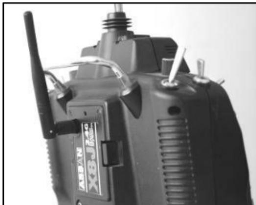
Установите съемную антенну и завинтите её в разъем на задней поверхности высокочастотного модуля ASSAN X8 2.4ГГц. Не затягивайте сильно, т.к. Вы можете повредить гнездо антенны.
