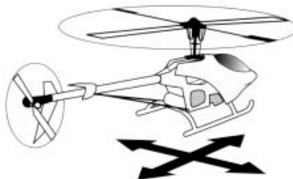
2. Перед тем, как поднять модель в воздух, при вращающемся роторе поработайте рукояткой крена/тангажа и убедитесь в том, что плоскость ротора наклоняется в соответствии с отклонениями рукоятки управления. Поработайте рукояткой управления хвостовым ротором и убедитесь, что модель стремится развернуться в заданном направлении.
