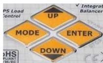
**РЕЖИМ(MODE):** *Перед тем, как зарядка начата* Пропускает пункты меню MEMORY(Память) (Зарядка), USER SETUP(Установки пользователя), DATA VIEW(Просмотр данных), BALANCER MODE(Режим балансировки); также выбирает режимы SOLO и SYNC.
