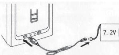
Соблюдая полярность, соедините разъем аккумулятора с соответствующим разъемом USB кабеля для зарядки, противоположный разъем USB кабеля вставьте в USB порт компьютера или USB зарядника для телефона. Рекомендуемое напряжение USB порта  $5В \pm 0.5В$ , время зарядки не более 120 минут.
